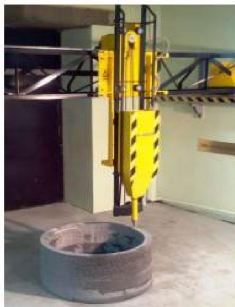
Рис. 5. Строительный 3D-принтер S-4063
