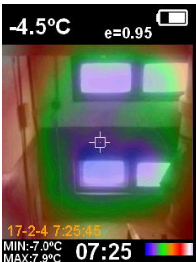
Рис. 7. Термограмма окон в подьезде жилого дома
