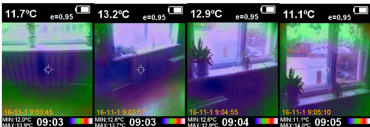
Рис. 6. Термограммы левого крыла коридора
