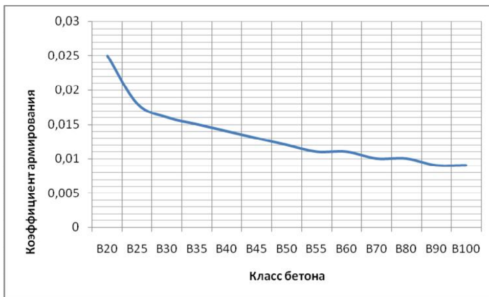
Рис. 1. Зависимость между классом бетона и предельным коэффициентом армирования
