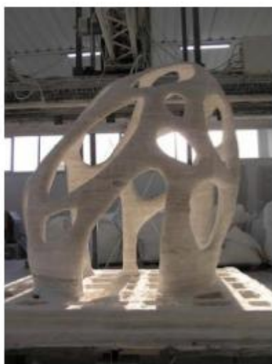
Рис. 3. Скульптура «Радиолярия», изготовленная по технологии D-Shape
