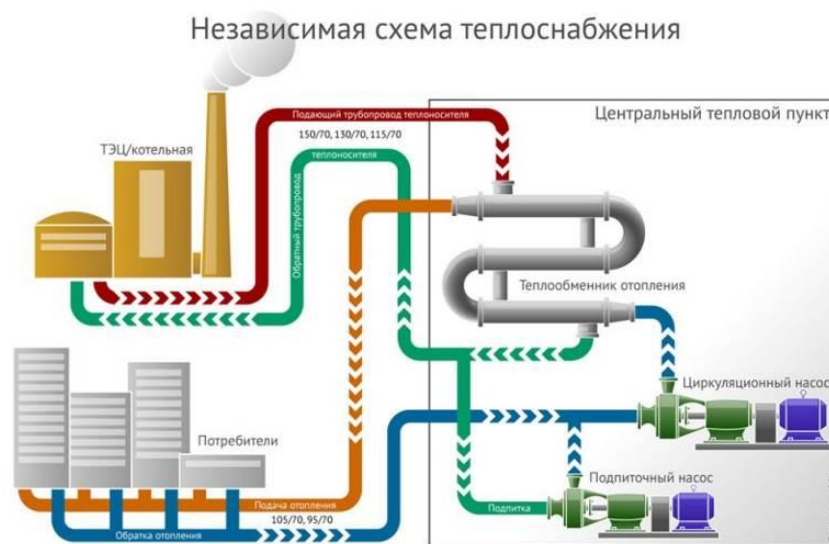
Рис. 1. Схема независимой системы теплоснабжения
