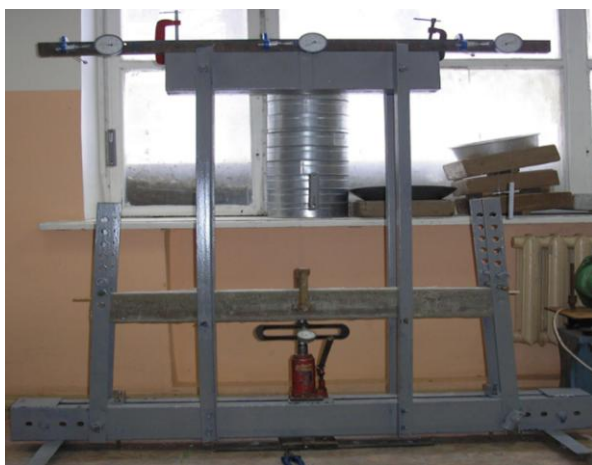
Рис. 1. Испытание балок на стенде
